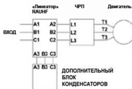
Типичная система ЧРП – «Линеатор» с отдельным дополнительным блоком конденсаторов
