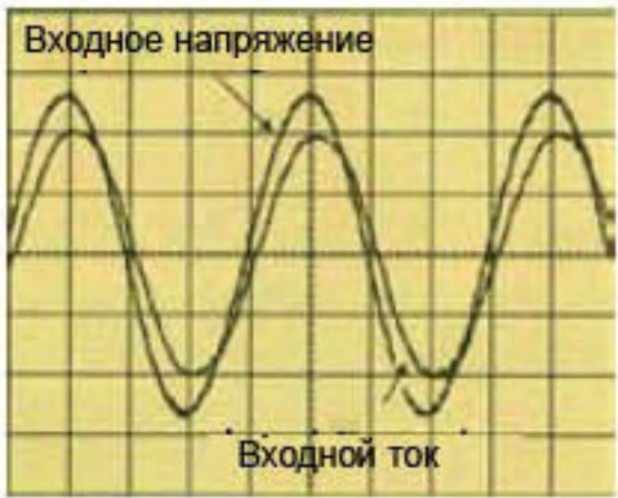
Типичная форма кривой входного тока и напряжения
