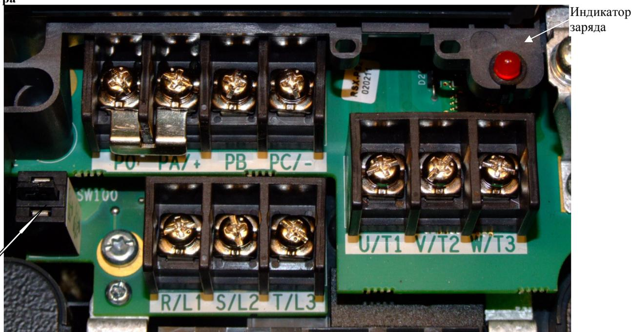
Переключение конденсаторов ЭМС-фильтра — малая емкость (**Small**) – отжать на себя, большая емкость (**Large**) - нажать
