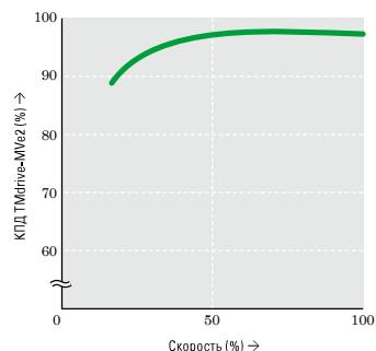
\* Пример реального результата испытания нагрузкой стандартного четырехполюсного электродвигателя на нашем заводе
